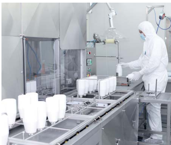
Nettoyage des composants en salle blanche classe A
